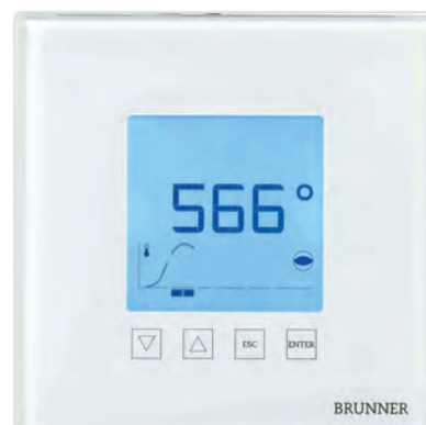
Elektronische Abbrandsteuerung EAS (17 x 17 cm). Automatisation der wichtigsten Funktionen einer rostlosen Holzbrand- Feuerstätte.
